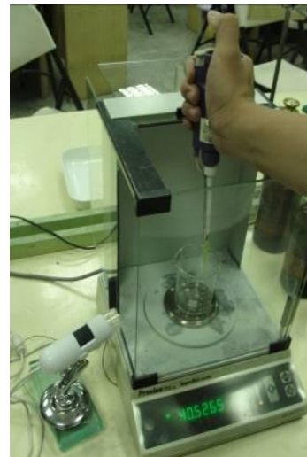
圖 8：滴入液體所測得增加重量
