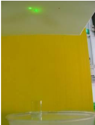
圖 7：反射光投影在珍珠板上產生偏差即代表不水平
