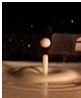
▲牛奶滴落液面後拉出液柱並分離出液珠
