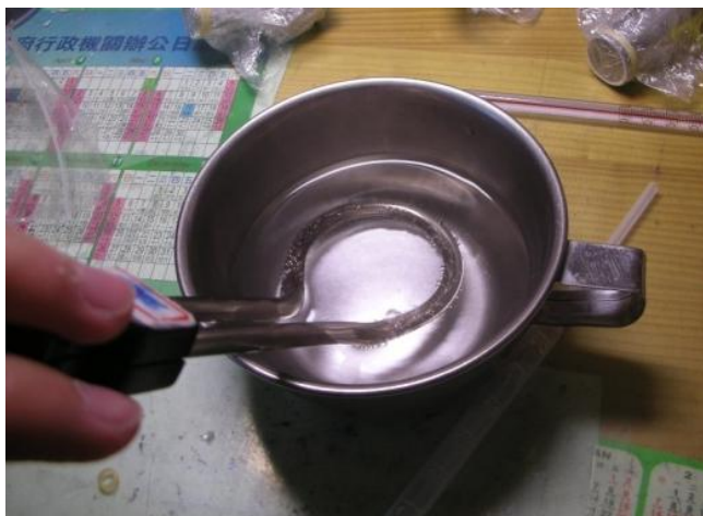
圖 4-6 利用電湯匙進行加熱，降低氣體溶解度。
