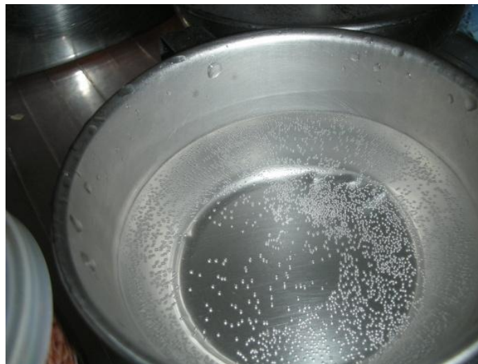
圖 4-5 將低溫之水，移至常溫後，因溶解度改變，造成氣體析出現象。
