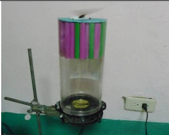
直流風洞的實驗裝置
