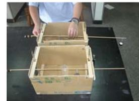
3. 當入射光點與平面鏡距離愈遠時，原反射線與新反射線在投影板上的投影位置差距就會愈大。
