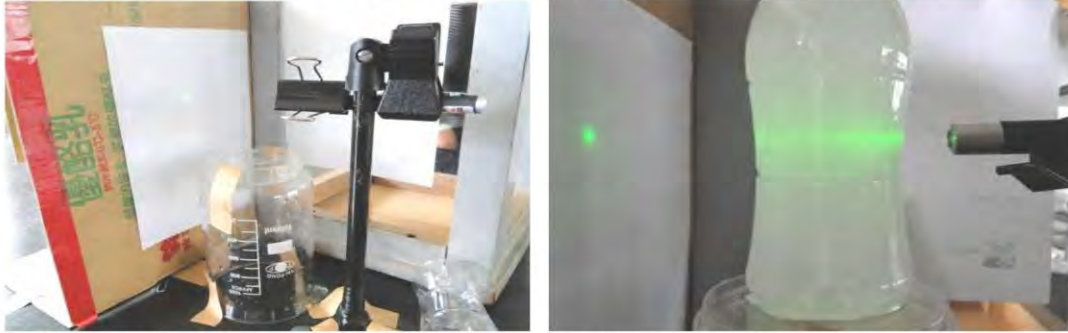
固定雷射光筆架及光點間距 雷射光筆透過高氧水的廷得耳效應
