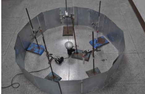
(圖十三)比較各材質抗輻射熱裝置 (圖十四)以燈泡給予輻射熱，觀察溫度變化
