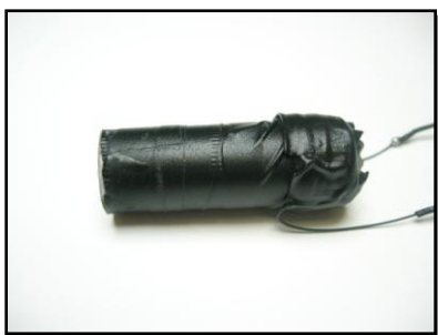
圖 3、設計創作： 光敏電阻感應管
