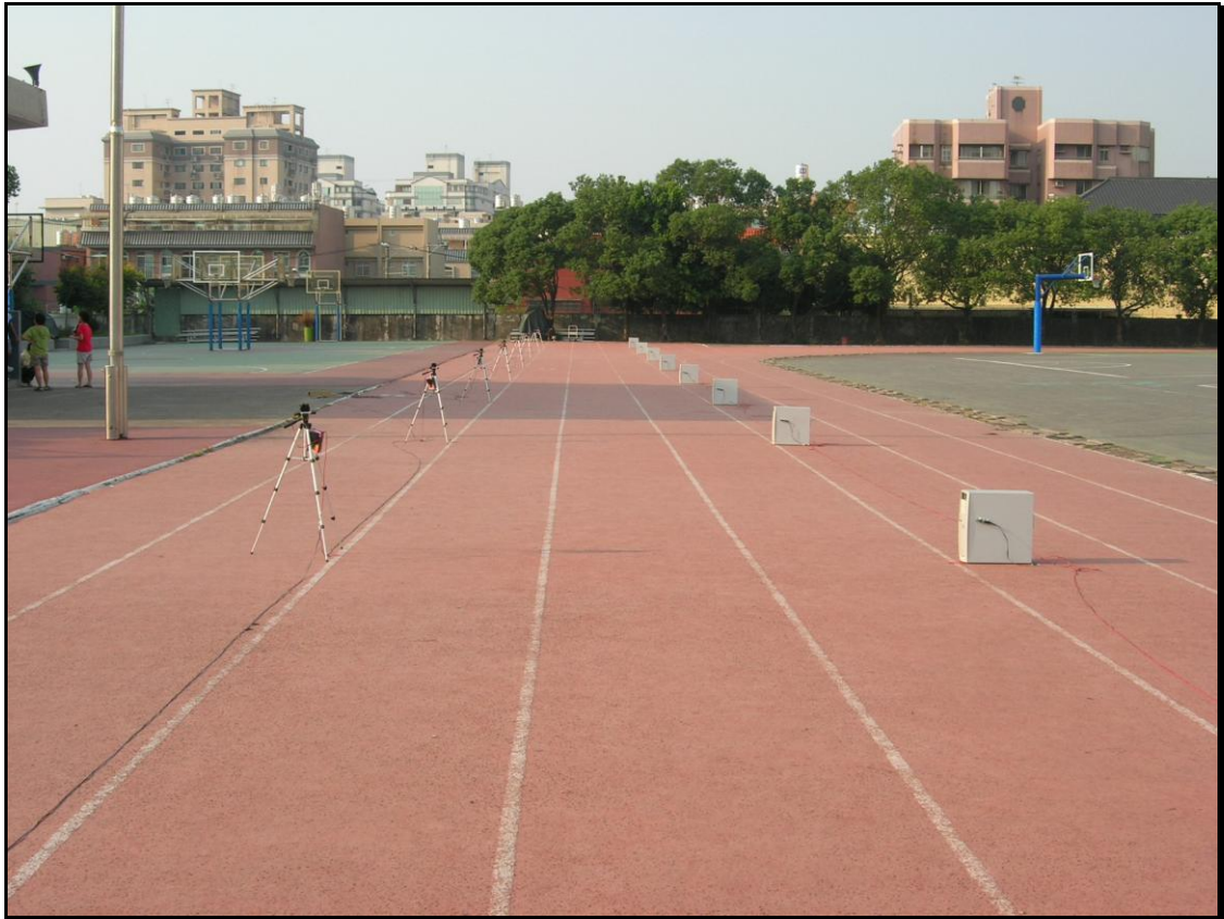
圖11、 操場大型雷射分段測速系統 --實際跑道佈置完成圖
