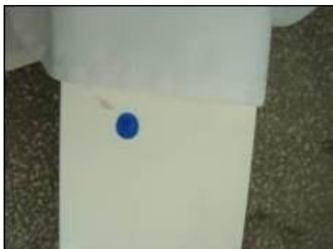
圖三-5 10°斜面墨水自動滾落，衣料表面毫無痕跡
