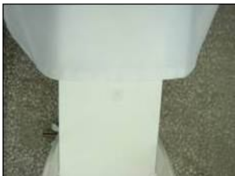
圖三-3 10°斜面水自動滾落，表面毫無痕跡
