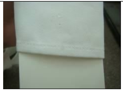
圖三-5 10°斜面墨水自動滾落，衣料表面毫無痕跡
