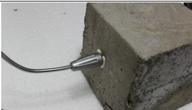
圖 8 麥克風細部圖(包覆泡綿膠以防震)
