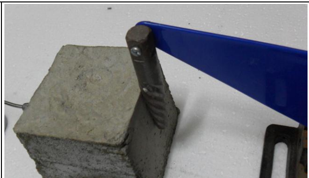
圖 9 鐵架及活動式鐵錘之細部圖
