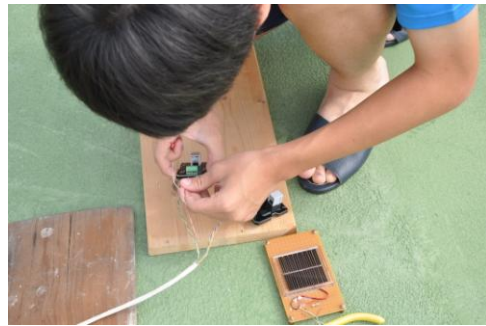
將連接線接到功率計 (電壓並聯，電流串聯)
