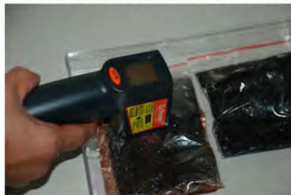
測量貼上銅箔「 模擬包 」表面不同位置的溫度
