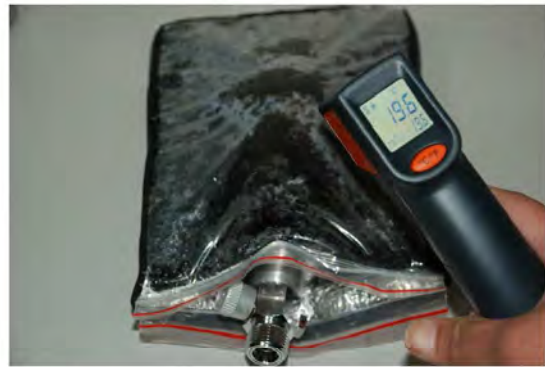
測量冰敷包皮膚接觸面的溫度
