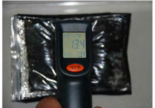
測量「冰敷包樣品」表面不同位置的溫度
