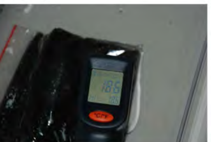
測量貼上無銅箔、鋁箔「 模擬包 」表面不同位置的溫度
