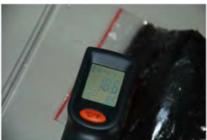
測量貼上無銅箔、鋁箔「 模擬包 」表面不同位置的溫度
