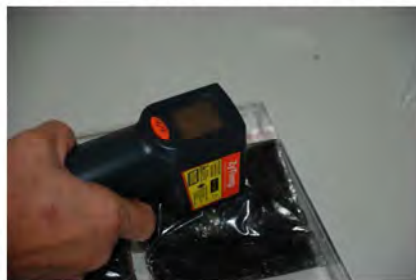
測量貼上鋁箔「 模擬包 」表面不同位置的溫度
