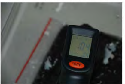
測量貼上無銅箔、鋁箔「 模擬包 」表面不同位置的溫度
