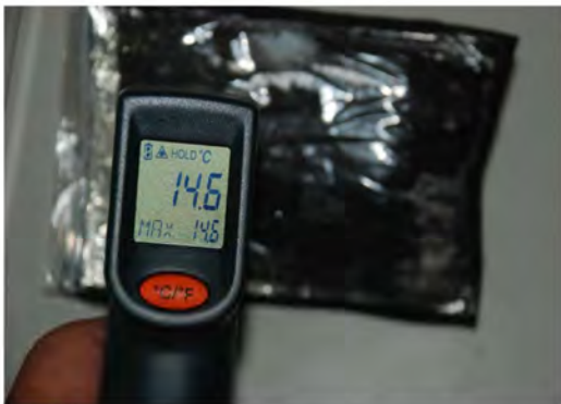
測量「冰敷包樣品」表面不同位置的溫度
