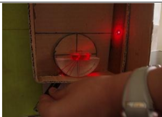
三之圖三 置 0%~100%糖水溶液於半圓形透鏡上，經雷射光折射於投影面上，然後畫上刻度。過程之三。
