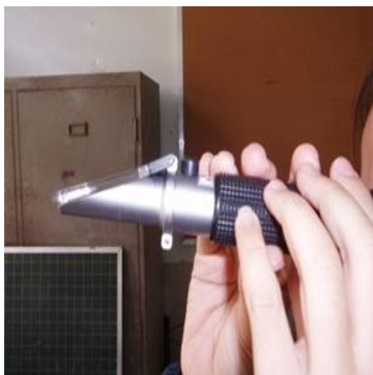
二之圖三 用高、中、低甜度計測標準溶液的甜度，向光源，並調焦，用眼睛觀察。
