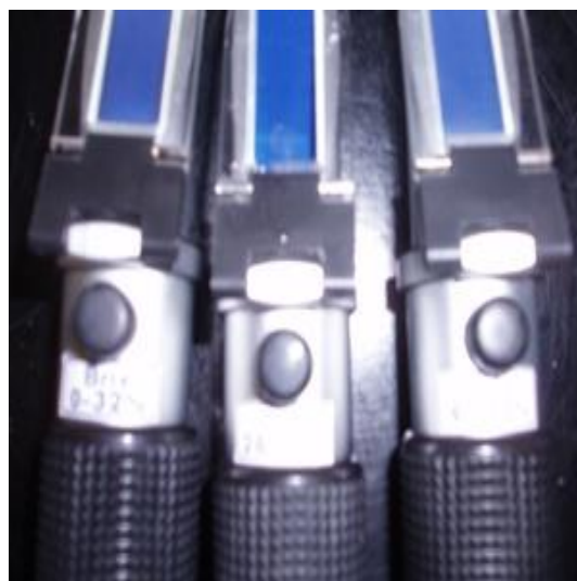
二之圖二 用高、中、低甜度計測標準溶液的甜度，做濃度與甜度的對照表之一。
