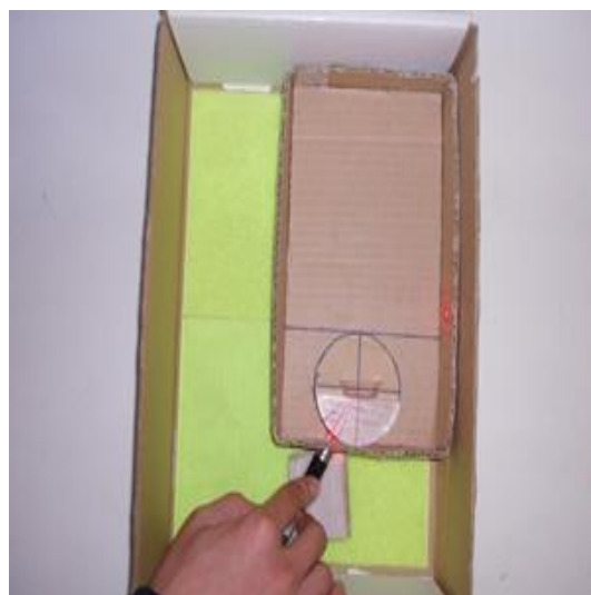
三之圖二 置 0%~100%糖水溶液於半圓形透鏡上，經雷射光折射於投影面上，然後畫上。刻度過程之二。
