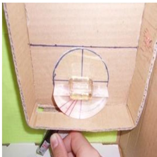
三之圖一 置 0%~100%糖水溶液於半圓形透鏡上，經雷射光折射於投影面上，然後畫上。刻度過程之一。
