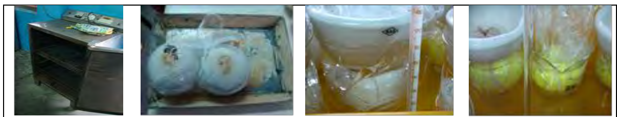
圖 18 5、6 號球放入蒸飯箱中，加熱完後拿出來大部分的球都有毀損；而隔水加熱時，隨時要注意溫度是否保持在 50°C，燒杯內外都要添加熱水使其保持水溫。
