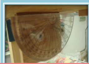
加上彈簧的量角器 以便精確量取擺角
