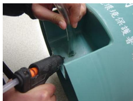
製作連通管觀測水位
