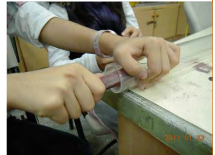
圖 17 製作壓克力管接頭-磨
