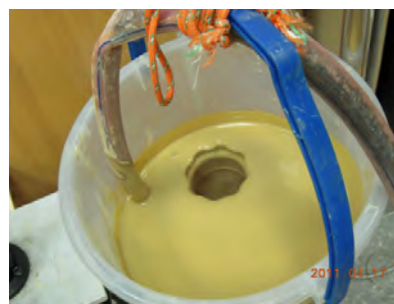
圖 38 水位控制器(改用泥漿)
