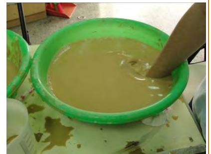
圖 20 陶土和水充分混合，得到泥漿
