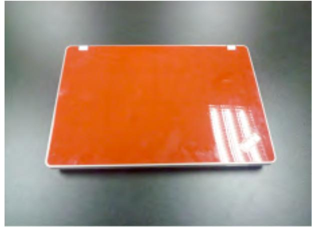
圖八、商用筆記型電腦（內建加速度感測器）
