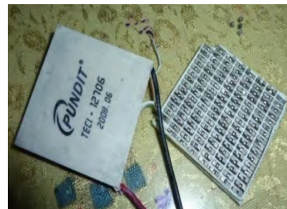
圖十六、致冷晶片內部構造
