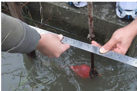
圖(八)：測量橡皮筋伸長量
