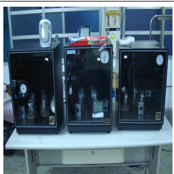
圖 9 濕度對黴菌生長的影響實驗設備與培養情形
