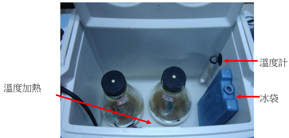
圖 7 利用溫度加熱棒及冰袋控制的恆溫水浴環境
