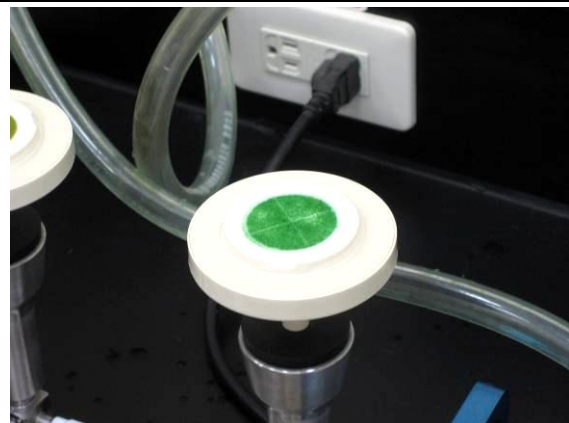
(照片 4-24) 待洗液流盡後繼續抽氣約 3 分鐘
