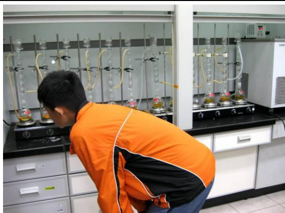
(照片 4-17) 重鉻酸鉀迴流法：沸騰後迴 流 2 小時，控制溫度，避免突沸
