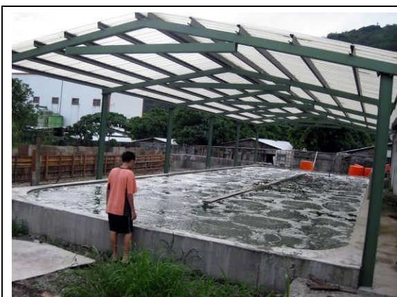
(照片 6-1) 50 噸的大型藍菌池：給予曝氣
