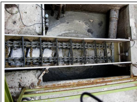
(照片 4-1) 固液分離機：以輸送帶配上鏟子撈起尿糞集中池中的豬糞便。
