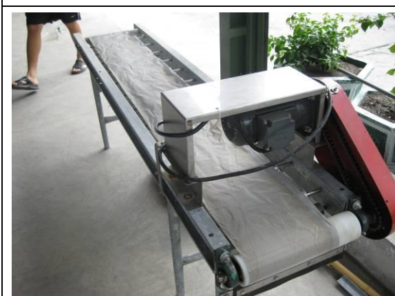
(照片 6-3) 以 400 目的濾網製作輸送帶，可全自動濾取藍菌以節省人力。
