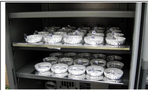
(照片 4-19) 事先做好玻璃纖維濾紙的空重
