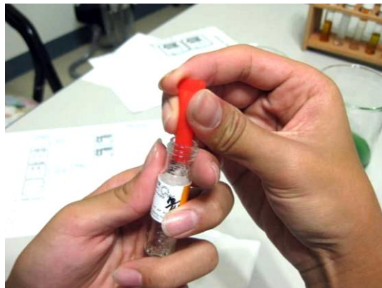
(照片 4-28) 添加試劑入檢測管反應
