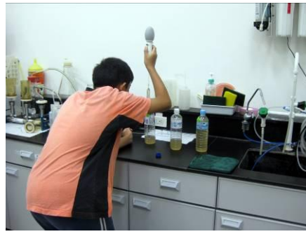
(照片 4-20) 依照樣水的濁度稀釋
