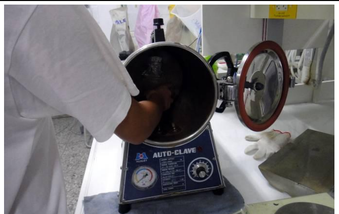
（照片 4-10）將「原廢水」高溫高壓 50 min 滅菌
