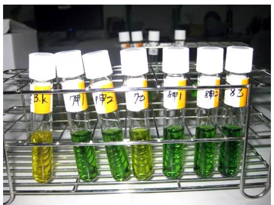
(照片 4-29) 依樣水濃度而有不同的變色反應
