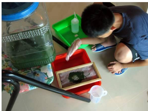
（照片 4-9）以孔隙 400 目的篩網過濾出藍菌來接種原廢水。
