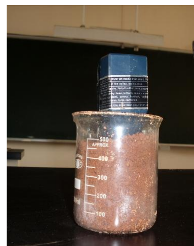
圖十八、加入碳酸鈣的土壤 200g (pH=3) 的酸土加入 40g 碳酸鈣，使土壤成為中性。
