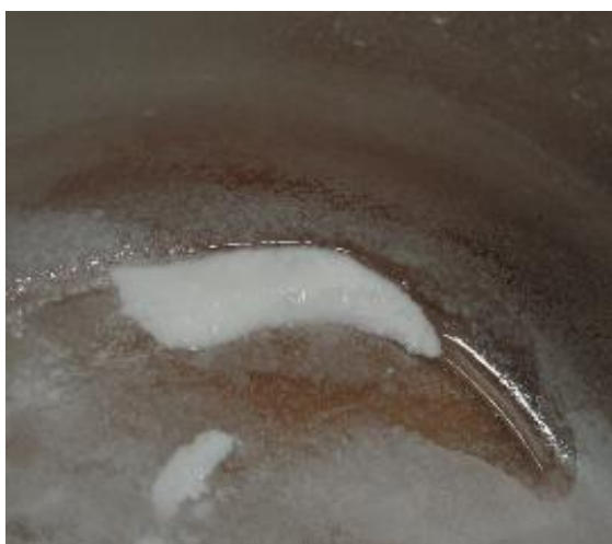
圖十三、電石渣水溶液曝氣後所產生之碳酸鈣沉澱物。
