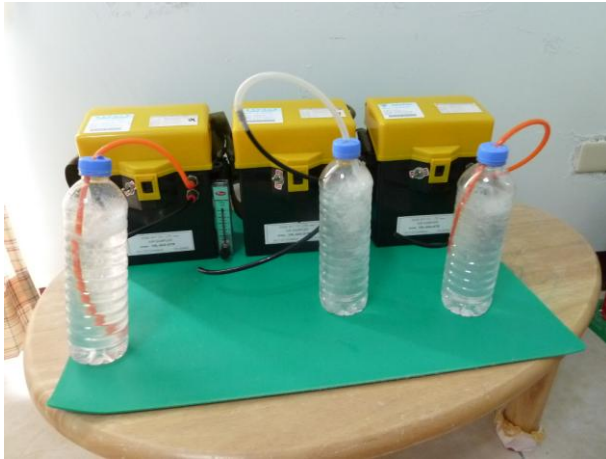
圖十四、定量打入空氣之裝置。
