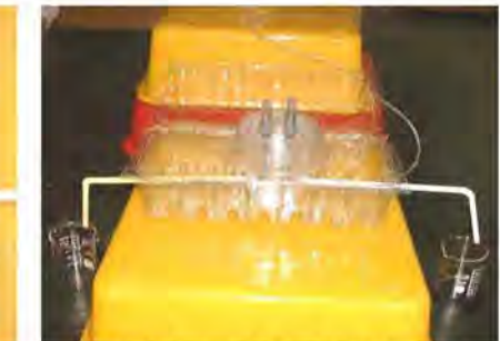
自製小型兩極分流電解槽完成圖
