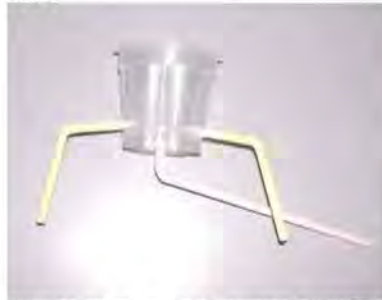
將可彎吸管再套接上去就成簡易的分流電解單槽
