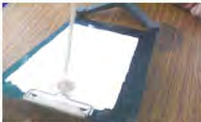
手抄再生紙以壓克力板夾住準備提高一邊當斜面
