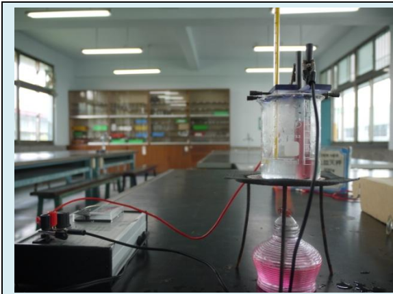
測量沸點的電解實驗裝置
