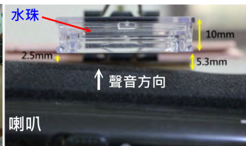
實驗裝置:喇叭與蒸發晶體平面的位置
