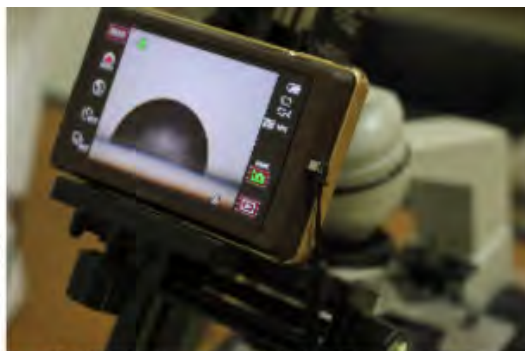
相機架在顯微鏡上, 拍攝側面
