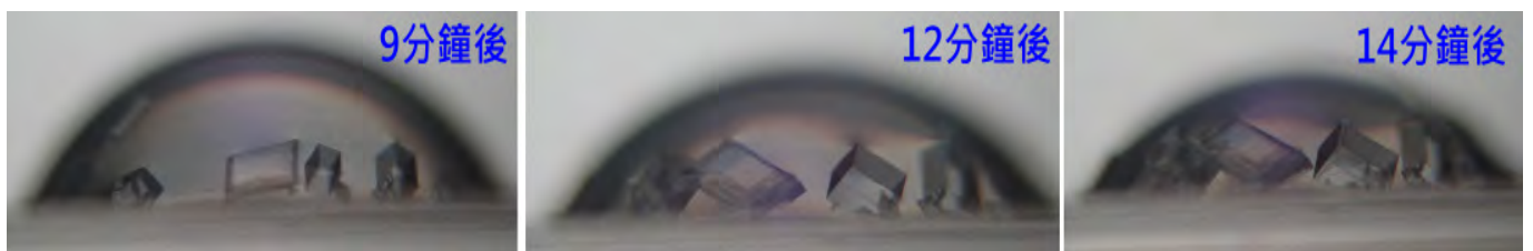
圖 17-2：側面拍攝完整水珠中硝酸鈉晶體成長變化（晶體在水珠底部成長）
