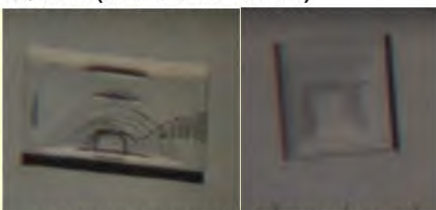
常溫下長出立方晶系的晶體,在外型上長方形與正方形兩種都有
