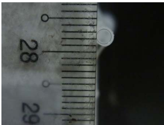
圖 4-4 用拍照法測針頭口的半徑
