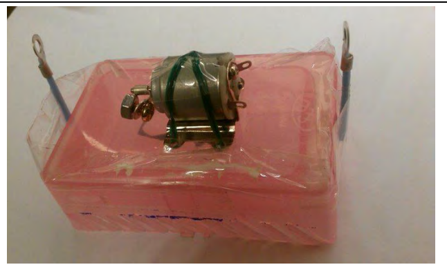
圖 23 二端以 R 端子導引方向
