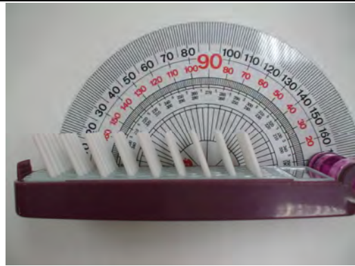
圖 29 調整梳子角度成 70^\circ 角
