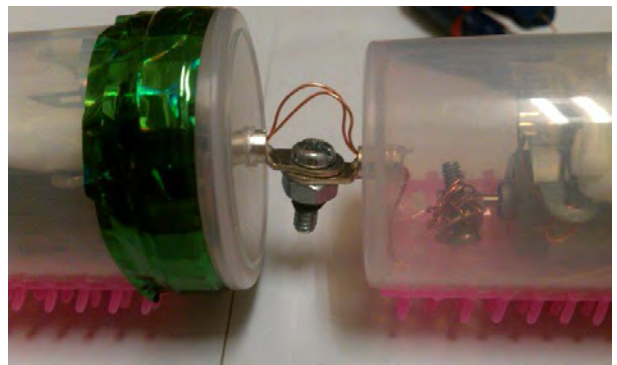
圖 39 導線、R 型端子與螺絲連接各節
