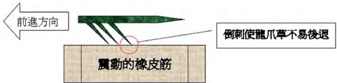
圖 63 倒刺結構使龍爪草不易後退
