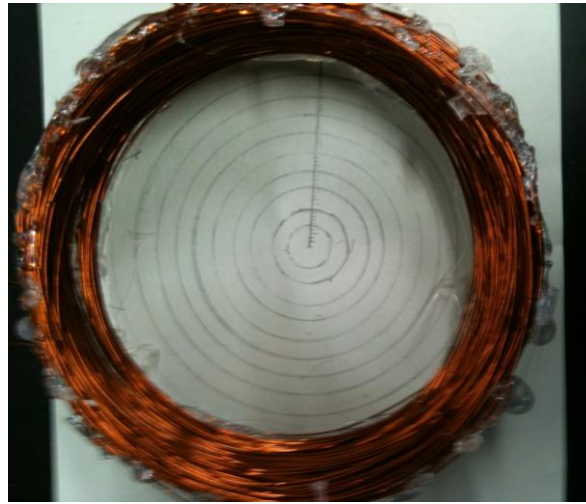
圖一. 線圈纏繞後以及觀察物體旋轉半徑的判讀器具
