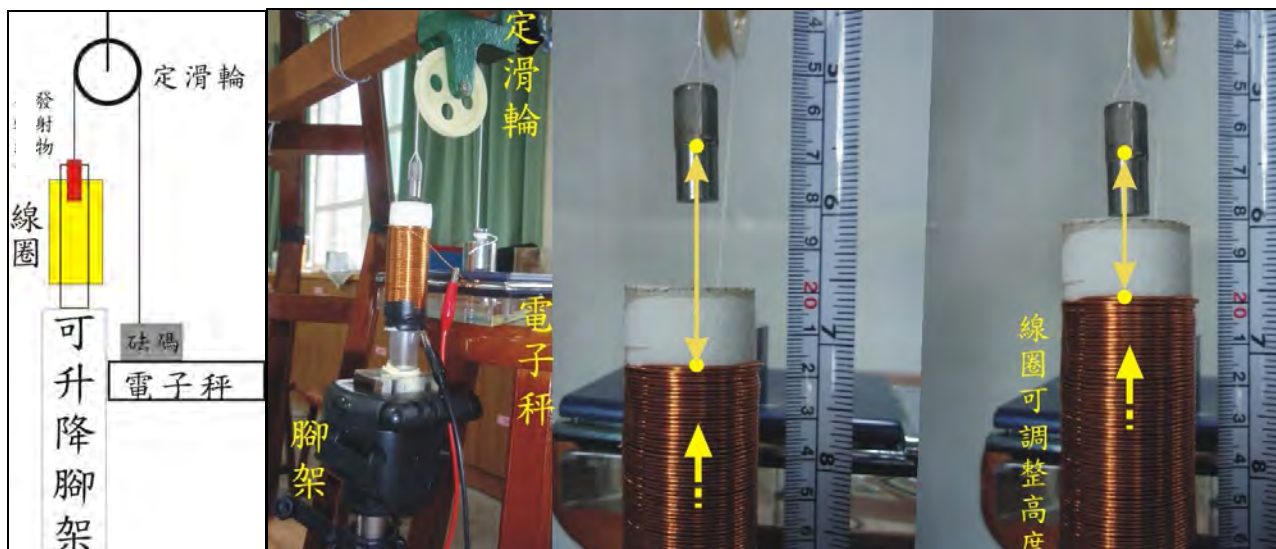
圖三 可調整高度的線圈測量鐵質物質心至線圈開口端的距離
