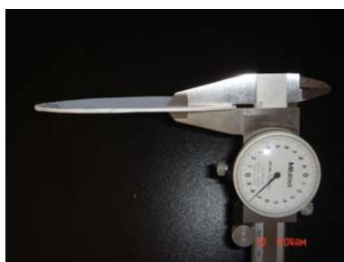
(圖 45)測量隔熱膠片
