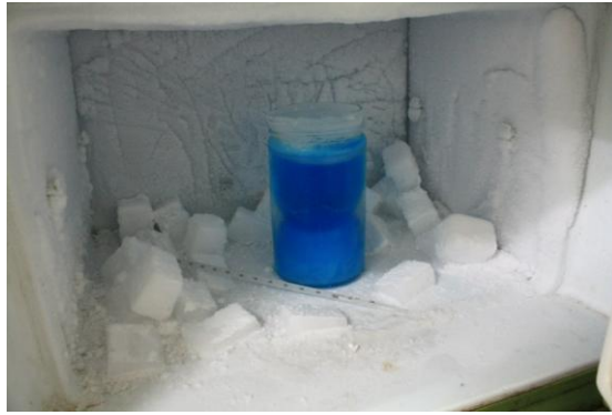
在冷凍庫中擺放乾冰，製造溫度更低的环境(-53°C) 使用乾冰冷卻的過程中，可以發現有色色柱內縮的腰身提高
