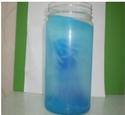
色素原本均勻分布， 結冰後形成中央色柱
