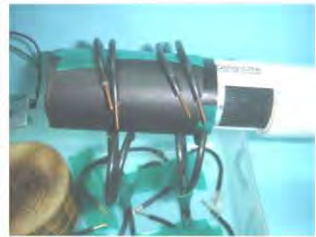
八爪角座承接可伸縮遮光紙筒及顯微鏡頭
