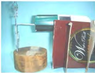
第一代承載液滴角座及承接顯微鏡頭紙架
