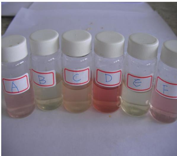
圖2-36紫試劑檢測金針乾製品的SO<sub>2</sub>殘留呈色
