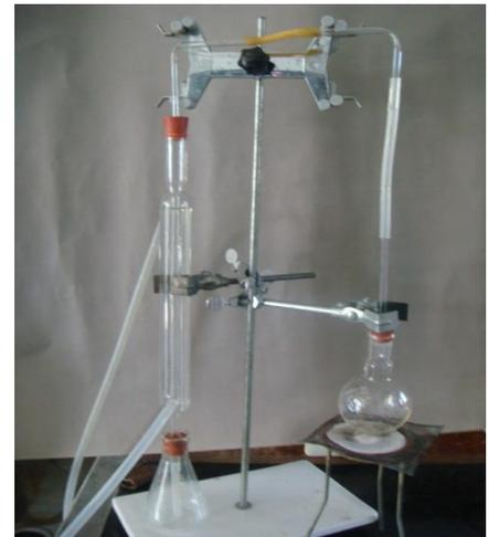
圖三醋酸鉛改良法設備
