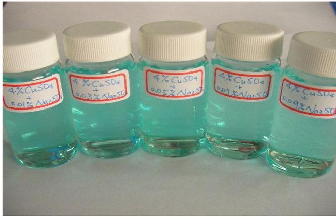
圖 2-15 測試 0.01~0.09 之%Na<sub>2</sub>SO<sub>3</sub>
