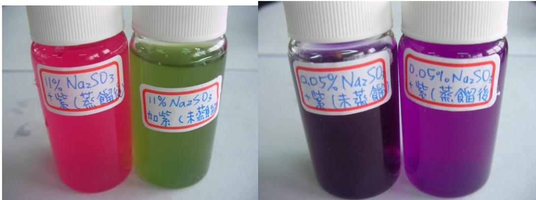
圖2-12-b紫高麗菜與+11%、0.05%的Na<sub>2</sub>SO<sub>3</sub> (未蒸餾) / SO<sub>2</sub>(蒸餾)之呈色差異
