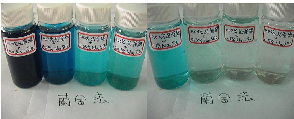
圖 2-24 以蘭金法收集 0.01~0.07%、0.1~0.7% $\text{Na}_2\text{SO}_3$
