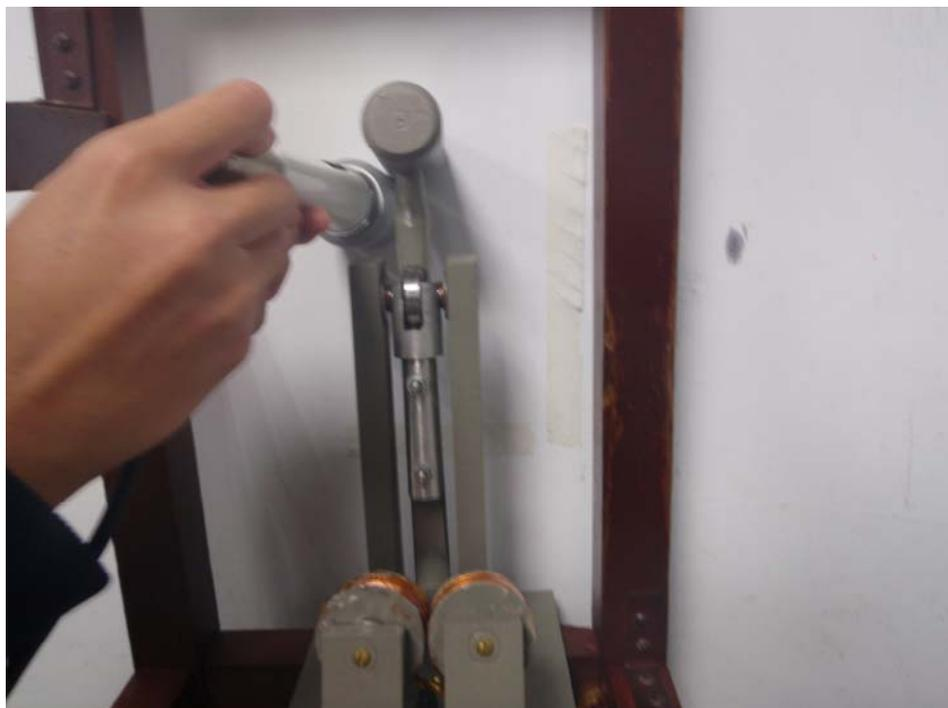
圖9 貼緊混凝土牆測試聲波
