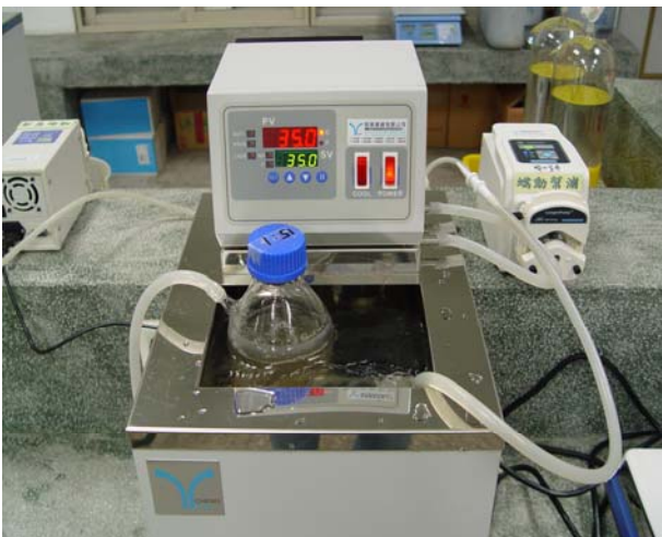
圖 16. 將產氫厭氣發酵槽定溫 35°C
