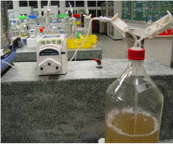
圖 22. 利用蠕動幫浦將基質送入發酵反應槽
