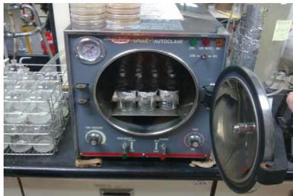
圖 3-13 高溫高壓滅菌釜內部情形
