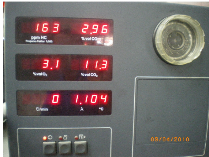
圖 12 原化油器式引擎機車之廢氣分析值
