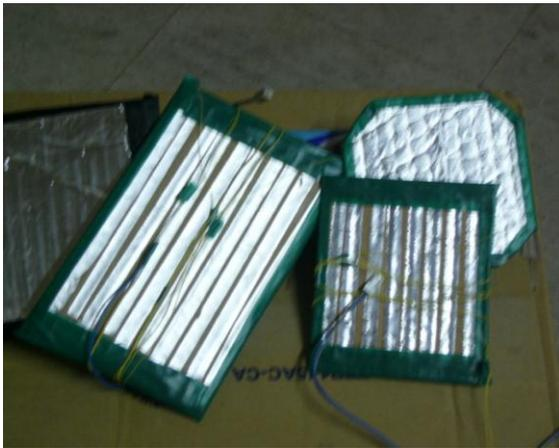
圖 4-1 接觸感測器使用厚紙板＋鋁箔紙
