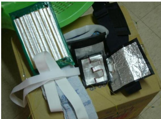
圖 4-3 接觸感測器使用軟布＋鋁片
