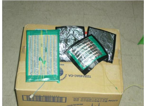
圖 4-2 接觸感測器使用軟布＋鋁箔紙
