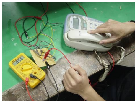
圖 8 電話與電阻串成一分壓電路形式，觀察話筒拿起與放下電壓變化
