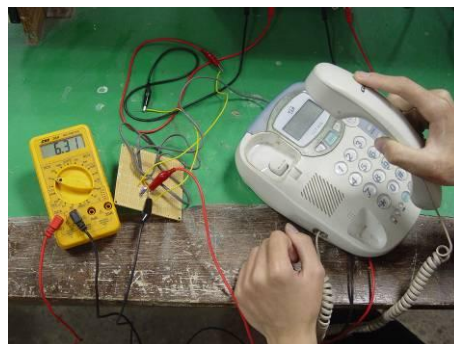
圖 8 電話與電阻串成一分壓電路形式，觀察話筒拿起與放下電壓變化
