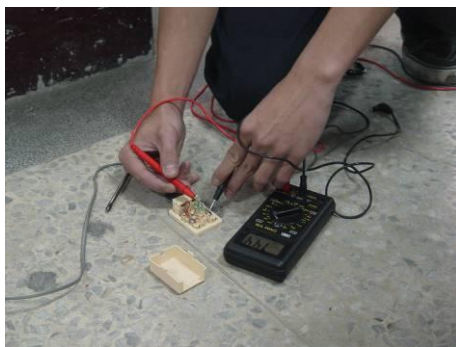
圖 4 電阻跨於電話線上，利用電錶量測可供應最大電流量
