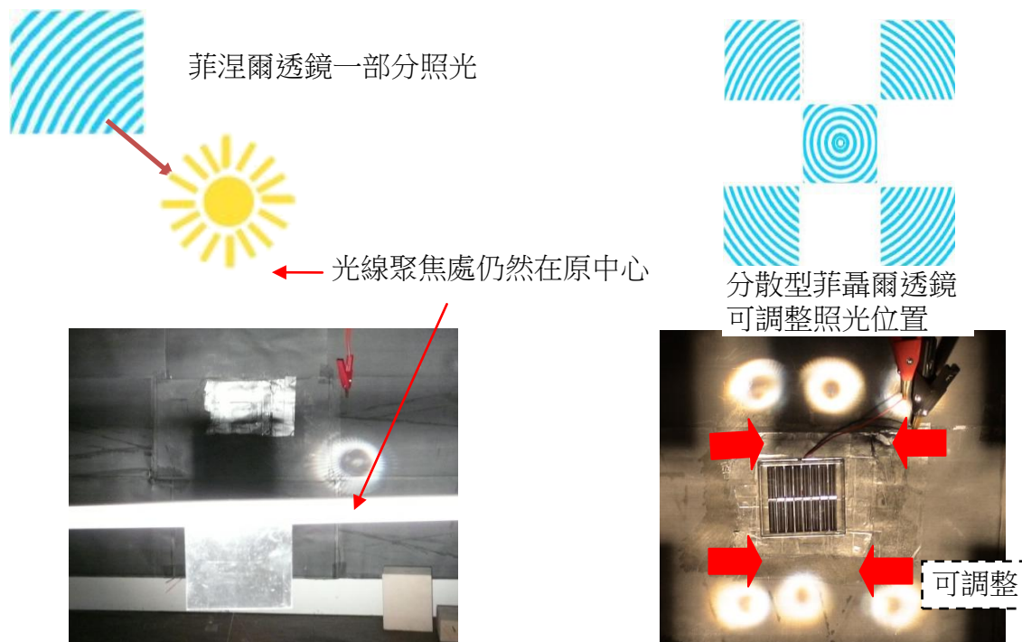
圖 6-2 利用分散式菲涅爾透鏡可調整照光位置
