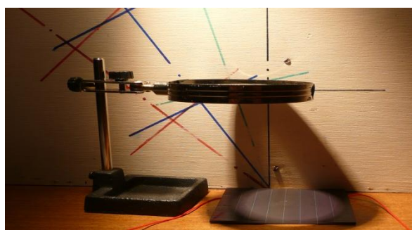
圖 5-5 透鏡距離導致陰影遮蓋太陽能板光照面積
