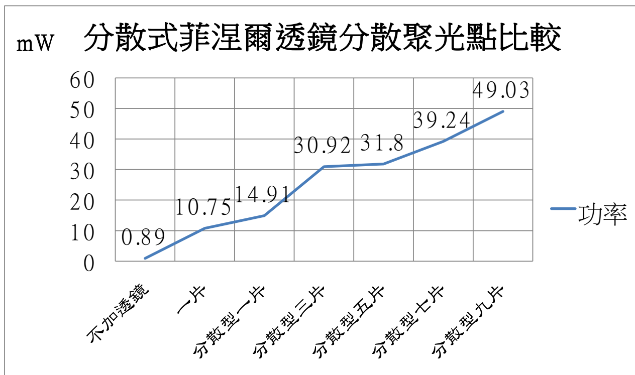
圖 5-10 分散式菲涅爾透鏡平均分散聚光點對太陽能發電功率影響
