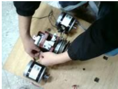
▲(圖二十三)安裝壓縮機
