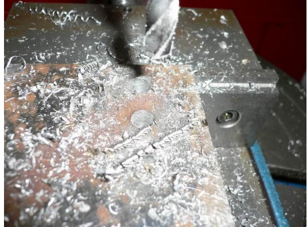
圖 35 偏心 0.25mm 鑽頭鑽削結果
