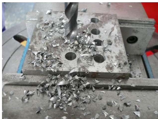
圖 38 偏心 1.0mm 鑽頭鑽削結果
