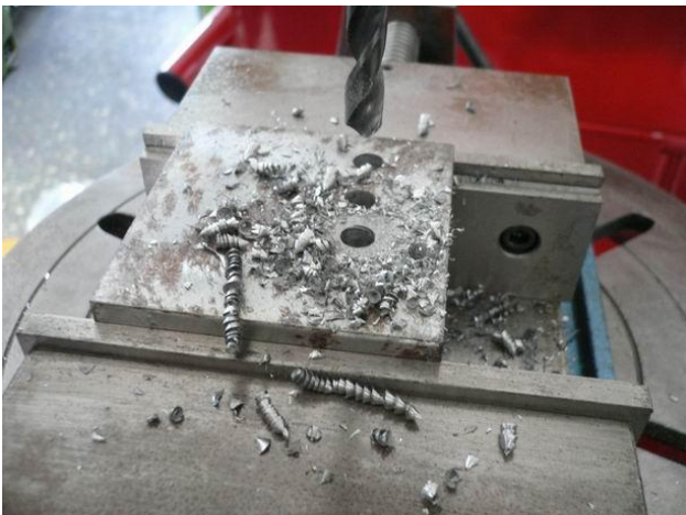
圖 36 偏心 0.5mm 鑽頭鑽削結果
