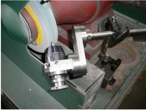
圖 21 研磨鑽頭時的刀角
