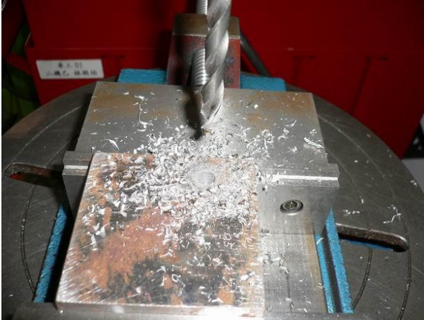
圖 34 無偏心研磨鑽頭鑽削結果
