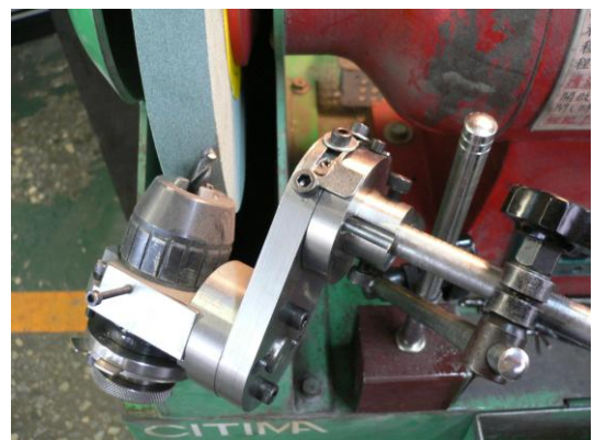
圖 20 組立完成的研磨附件
