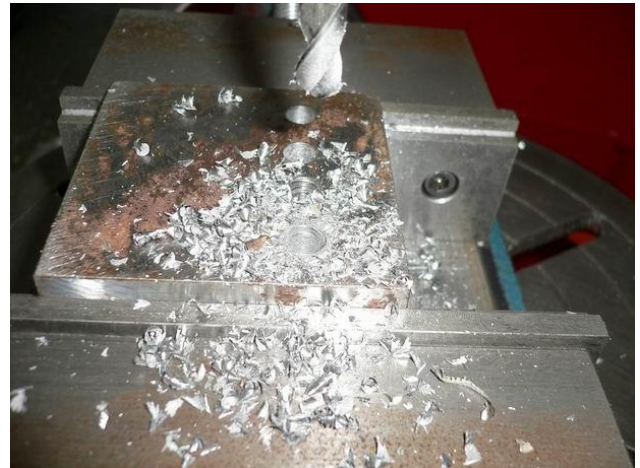
圖 37 偏心 0.75mm 鑽頭鑽削結果
