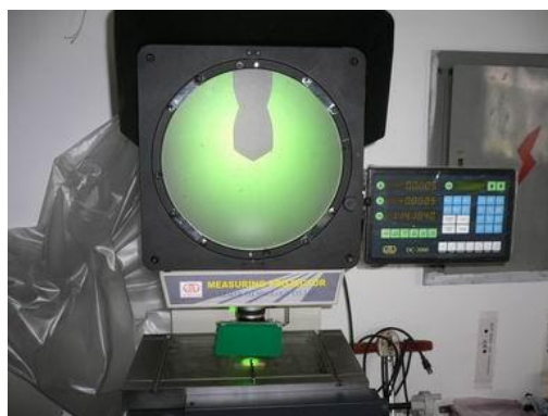
圖 58 光學投影機檢驗鑽唇間隙角
