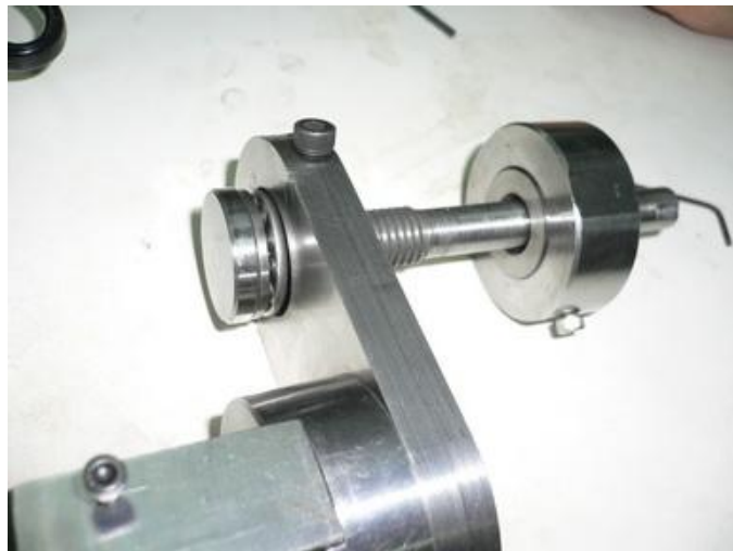
圖 29 使用兩顆止推軸承，使偏轉由滑動變為滾動
