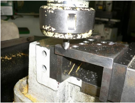
圖 43 以銑床對工件邊緣做倒角工作
