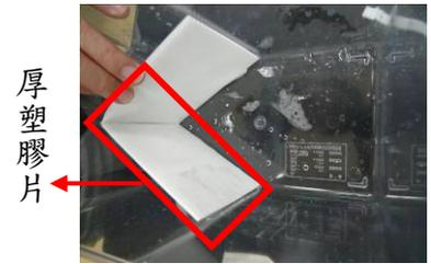
二、原本討論到冰棍堅固程度的時候，我們想拿冰棍敲桌子，看誰比較堅固。但是發現這樣的做法每次用的力量不一定一樣，實驗不公平。後來找尋網路資料發現，**要知道堅固程度，要測的是脆度，可以用三點測折斷法。所以我們利用教室有的東西，模仿三點測折斷儀器。**
