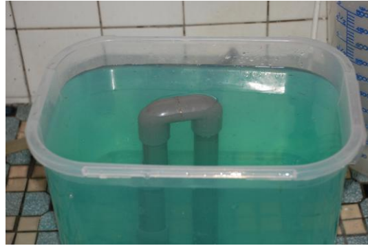
水面高度超過「高水線」，虹吸作用發生
