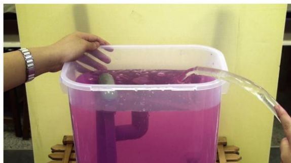
持續補水使水面昇至「低水點」
