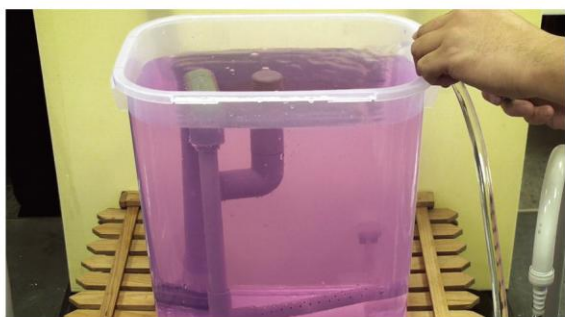
持續補水使「下入水口」進水
