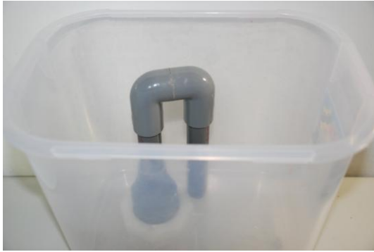
製作測試「沉浸式虹吸管」的水箱
