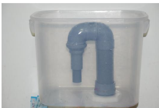
將第虹吸管裝入測試水箱中
