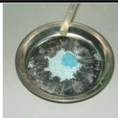
圖 4.21 管壁生成物滴入無水硫酸銅後情形
