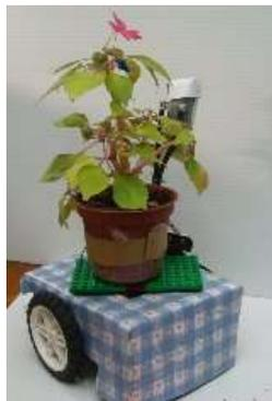
圖 7.5 含光感測器、濕度感測器的植物照護系統
