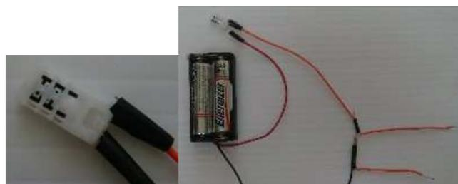
圖 7.3 濕度感測器和電路
