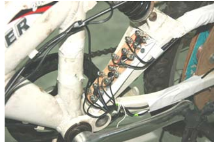
整流器裝在後輪支架下
