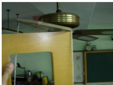
(測量出扇葉的角度 23 度)
