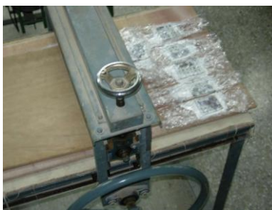
(調整滾輪機壓緊扇葉)
