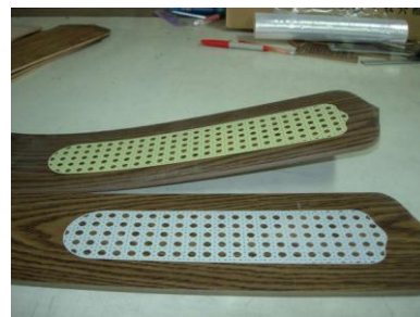
(彎曲扇葉翹起的情形)
