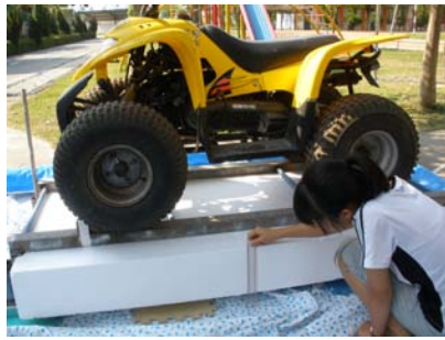
說明：測量未注水時車位高度
