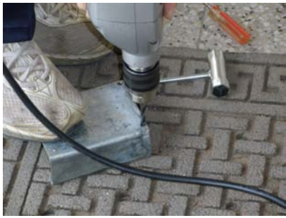
說明：老師幫忙在 C 型鋼鑽孔作為車庫底座
