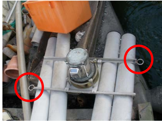
說明：鐵環與鐵柱保留空隙，可上水車隨浮力上升下降
