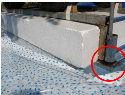
說明：車位未浮起時，左側支柱與框架相對位置
